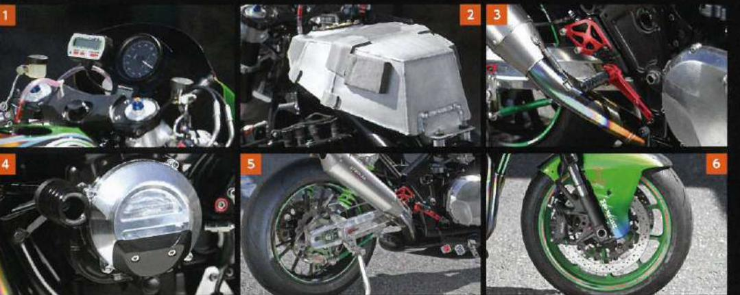
1 永井電子製ULTRA回転計を中央に置くコクピット。Fブレーキ/クラッチマスターはブレンボラジアル。ステムまわりは倒立フォークとともにZX-14R用で、バランスはかなりよいこと。タンクはアルミインナー式で容量は約14l
