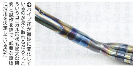
④写真はZRX1200ダグ用だが、ネイキッドなので最低地上高を確保しつつ集合部を目立たせている。しかしモデルによっては4-2部分を横置きにし、最低地上高をかせぐことも
