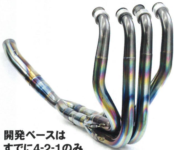
④写真はZRX1200ダグ用だが、ネイキッドなので最低地上高を確保しつつ集合部を目立たせている。しかしモデルによっては4-2部分を横置きにし、最低地上高をかせぐことも
