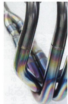
④この排気口近くにパイプを設けるケースもあるが、そういったパイプの有無も研究と実験によって導き出された構造。安易な真似は厳禁だ
