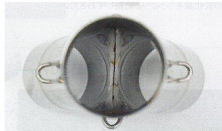
④集合部の長さや角度も実は性能を左右するパーツ。「単純な構造だからこそもちよとの違いが生じます。購入後にはなると思いますが、こういったパーツにも注目いただければと思います」
