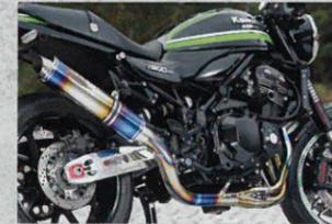
⑦マフラーにはストライカーを採用する。集合方式を4-1としつつ、集合部をセパレート構造とすることで中低速もしっかりと確保した。もちろんJMCA認証だ
