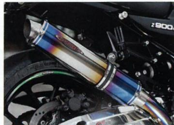
④真円のチタンサイレンサーを採用。そのサイズは直径100mm、全長400mmという絶妙なサイズで設計される。ジェントルながらも力強いエキゾーストノートを響かせる。なお写真はオプション設定のチタンヒートカラーだ
