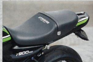
①ライディングポジション構築の要のひとつでもあるシートもオリジナル。座面の形状、硬さを見直してリヤのトラクションがつかみやすい、好みの形状などのリクエストも可
