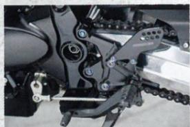
④ライディングポジション構築のキモとなるステップ。いたずらに下げるのではなく、最適な位置で設定し、4ポジションとすることで体格や好みに対応する
