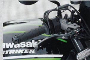
②ブレーキマスターはプレンのRCSラジアルポンプに変更している。ブレーキキャリパー、ディスク変更によって強大となった制動力を、精密にコントロールする
