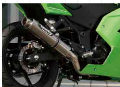
→フルチタン製フルエキゾーストマフラーも発売中。JMCAに対応するなどストリート走行にも対応する他、レース仕様サイレンサーも用意される
