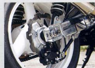
④リアブレーキもフロントと合わせて、ブラックカラーのブレンボキャリパーとガルファーφ250mmの組み合わせた。制動力の強化だけでなく、コントロール性も意識している
