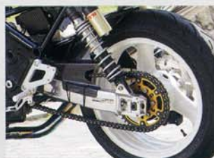
⑤現在廃版となっている中古のストライカーオリジナルスイングアームが装着されている。ZRX1200ダエグのリアショックを組み合わせて、ローコストで性能アップを図った
