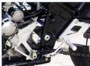
②ストライカーのDPSステップを採用。現在タンデムステップは装着されていないが、タンデム位置がノーマルマフラーとアップマフラーをかわす位置に変えられるのが特徴となっている
