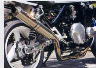
③マフラーにはストライカーのサーキットスペシャルタイプが装着された。低中速域のトルク感と、高回転域で伸びのある特性により、街乗り&ハイベースな走行にも対応するという
