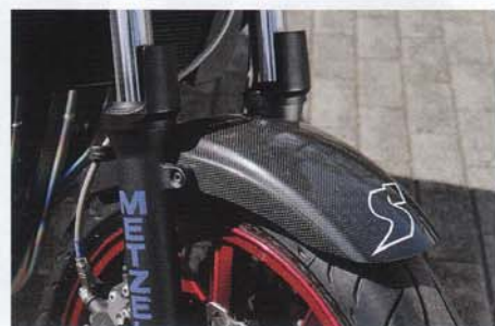
⑨カラーズインターナショナルのデモカスタム、ZRX1200ダエグに装着されたSAD。わずかながら軽量化にも貢献し、それでいて細部のディテールが魅力的なデザインである
