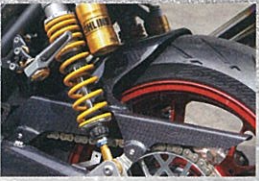
アルミ丸パイプのスイングアームを包み込むカーボン製のアンダーアーマー(3万9900円)。エンジン下部へのドロ跳ねも防止する
