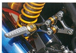
タンデムキット(3万3600円)はステップやマフラー交換した際に便利な車検の必需品。別売のステーでサイレンサーの支持も可能
