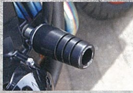
ジュラルミンベースのジュラコン製ガードスライダー(1万1550円)。万一の転倒時にダメージを最小限に防いでくれる
