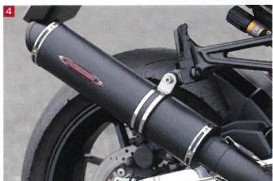
①フロントパイプはコニカルテーパー形状を採用。②集合部はZ900RSのスタイリングとのマッチングを考慮して、4-1ルックのセパレーター内蔵4-1構造。③サイレンサーはラウンドタイプ。異形ひし形断面形状とカーボン製テールエンドピースを装備する「OFF-Type」サイレンサー仕様もラインナップ。④ツヤ消しブラックが精悍な印象を与える、セラコートは今までにない高い耐久性を誇る特殊コーティング。
