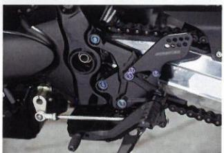
↑ライディングポジション構築のポイントとなるステップ。4ポジションとすることで体格や好みに対応しており、部品の高精度化で操作性も格段に向かっている
