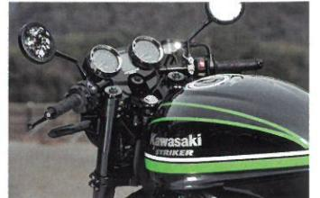
↑変更ポイントの一つがブレケットだ。ストライカーのステムキットで、倒立フロントフォークとの剛性バランスを適正化し、ハンドリングがスポーティとなった
