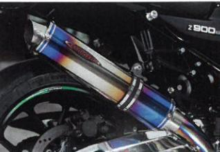
↑マフラーは当然ながらストライカーを採用する。集合方式は4-1だが、集合部をセバレー構造とすることで、低中回転域に配慮している
