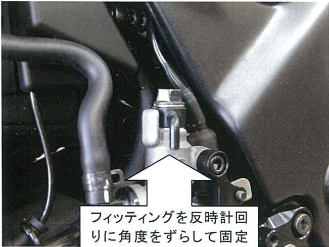
フィッティングを反時計回りに角度をずらして固定し、フィッティングがフレームやスイッチに干渉しないようにします
