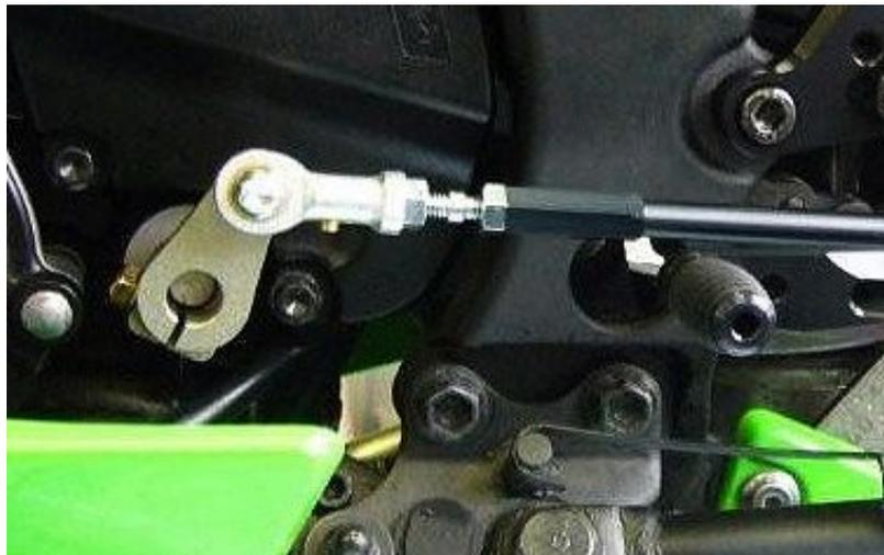
逆シフトチェンジで使用される場合は、付属のチェンジアーム(No.37)を反転してお取り付けし、上記の画像を参考に各部の角度を合せながら作業を行って下さい。ひと山角度が変わると、エンジン側のウォーターポンプカバーとチェンジアームの締め付け部フランジボルト(No.34)が干渉しボルトの締付が出来ませんのでご注意ください。
