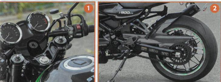
12 ストリートHi (STD:垂れ角ほぼ0) /Low、レーシングHi (垂れ角5度) /Lowで開き角自由のGストライカーセパレートハンドルキット。トップブリッジ、セパレートハンドルの単品販売もあり。スイングアームはGストライカー。SADカーボンフェンダーはノーマルから250mm延長され泥・水跳ねを軽減する
