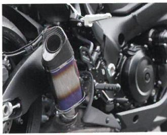
↑異形断面のアウターにカーボンシェルのエンド部を組み合わせたレーシーなサイレンサーでドレスアップ効果も高い。もちろんノーマルステップでも装着可能だ。
