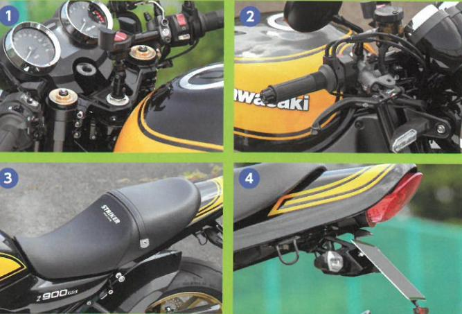
1 2 3 4 ストリートHi（STD: 垂れ角ほぼ0）/Low、レーシングHi（垂れ角5度）/Lowで開き角自由のGストライカーセパレートハンドルキット（Z2ショートミラー込みでの販売）はこの車両の核をなす部分。自然に手が出る位置でハンドルが握れるポジション設定だ。Fマスターはブレンボラジアルでシートはオリジナル張り替え。フェンダーレスキットは独自の削り出し立体ステーによるもの
