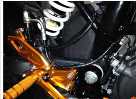
チェンジアームをチェンジシャフト下側に付けると正チェンジ、上側に付けると逆チェンジになります。クラッシュバー(エンジンガード)を装着している車両は逆チェンジにできませんのでご注意ください。
