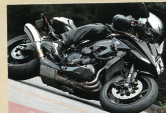
↑重心から遠いところにあるマフラーを軽量化することは、運動性能アップに大きく貢献。軽快な走りを体験したら、もう元に戻れない!
