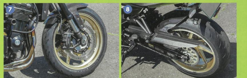
**789** フロントのφ41mm倒立フォークやホリゾンタルバックリンクのリヤサスはノーマルで、ブレーキシステムもすべてノーマル。S7-020ではサスチューニングまたは換装、ブレーキ換装もカスタム
