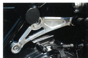
↑エンジンハンガーを質感の高いアルミピレットで製作。スタイリッシュなうえに剛性アップも見込める。ヘッド側は販売中、シリンダー側は近日発売
