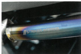
↑グラブバーはチタン製で、なんと手曲げて製作。機能面で意味があるかはさておき、この質感の高さには、無条件にひかれるものがある。ハイエンドカスタムに相応しいパーツだ
