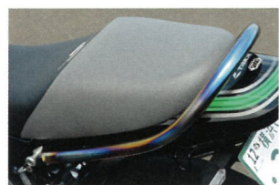
↑ストライカーワークスのチタンカスタムグラブバー。カスタムを進めると、純正のグラブバーが見失うというユーザーの声にこたえて製作された
