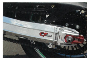
↑Gストライカー swingarm のオプションに、新型チェーン引きが登場。チェーン調整が容易で、アビランスも高い。セラコート仕様もテスト中
