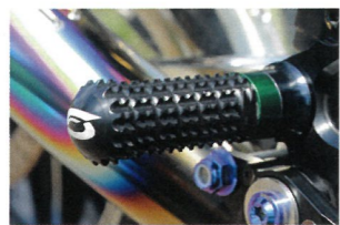
↑一般的なローレット加工ではなく、総削り出しで製作し、絶大なグリップを実現したステップバー。ストライカーのステップのオプションパーツ
