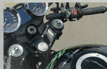
↑大好評のZ900RS用セパレートハンドルキット。無理のないポジション、ハンドルロック使用可能。周辺パーツとの干渉も配慮した、セパレートハンドル化にもなる問題を解消するキット
