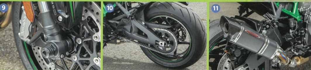
9 10 11 フロントアクスル両端には「STRIKER アクスルスライダー フロント KAWASAKI Z H2」(1万1000円+税)を装着。純正アクスルシャフトにボルトオン装着。マフラーは「STRIKER "INTER MODEL" RC SLIP-ON OFF-Type B レーシング Kawasaki Z H2」(11=CKブラックは12万5000円+税、チタンソリッド/チタンヒートカラーは各11万5000円+税)。チタンボディ+カーボンエンドで重量1.5kg(ノーマル7.5kg)。車検非対応品
