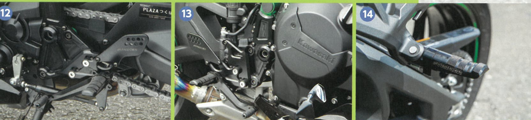
12 13 14 ステップは9月下旬発売予定(取材時点で予約受付中)の「STRIKER スポーツツーリングコンセプト"STC"STEP KIT 6ポジション KAWASAKI Z H2」(12.10万5000円+税)。純正でステップベースを外すと露出部がパイプではないため、ここをカバーするようにフルプレートで設計された(13)。ポジションは後ろ×上に①20×20(mm、以下同)、②20×30、③30×20、④30×30、⑤40×20、⑥40×30の6つ。タンデム側バーも「オリジナルタンデムステップバー"STC"カワサキType1 KAWASAKI」(14.1万7000円+税)に
