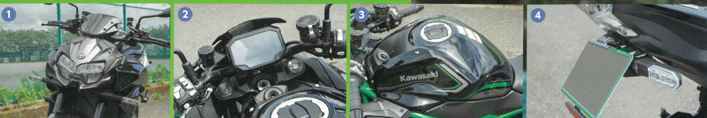
1 2 3 4 SugomiデザインによるフロントマスクやNISSINラジアルの左右マスターシリンダー、多機能デジタルTFTワンプネルのメーターなど外装まわりはZ H2のノーマル。テールには「STRIKER アルミビレットフェンダーレスキット KAWASAKI Z H2」(2万6000円+税)が装着される。天板とナンバープレートステーをつなぐステーが立体削り出しで、すっきりしたリアビューとカスタムルックを作る。初回限定の緑は完売、黒は販売中
