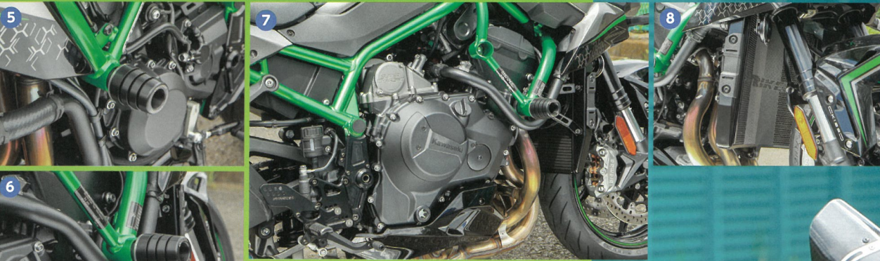
5 6 7 8 スーパーチャージャーを装備の998cc直4エンジンや銅管トリスフレームはZ H2のノーマル。ラジエーター部にはステンレス製でスモークガンメタ仕上げの「STRIKER ラジエーターコアガード KAWASAKI Z H2」(8.3万5000円)を装着。シリンダーサイドには「STRIKER ガードスライダー KAWASAKI Z H2」(5.6=標準仕様、1万3000円+税。ベースもブラックのオールブラックは1万5000円+税。カーボンコンボジット仕様は2万5000円+税)も装着
