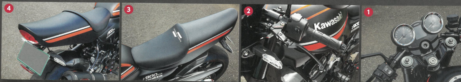
1 2 3 4 Z900RSに適した自然なフロント荷重をかけられ、垂れ角(0/5度調整可能でハンドル位置も2段の計4ポジション)やコーナリング時に肘が自然になるような幅まで吟味したGストライカー・セパレートハンドルキット+ピレットアンダーブラケットは引き続き
