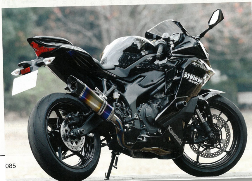
⑨ストライカーの主力商品のひとつであるステップキットも当然ニンジャZX-25R用が用意される。純正オプションクイックシフター・STDシフターなしに対応。4ポジションのマルチポジションタイプだ。別売りのパーツで逆シフトにも対応。基本はブラックだが、プラス1万3,200円でカラーオーダーすることができる。2月下旬から3月中旬にリリース予定で、価格は6万500円
