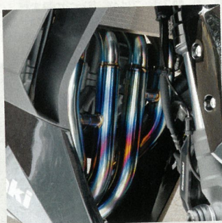
⑤カウルで見えないが、エキゾーストパイプにも焼き色が入る。チタンコニカルテーパーパイプにパイプが加えられ、集合方式は4・2・1。価格は22万1000円
