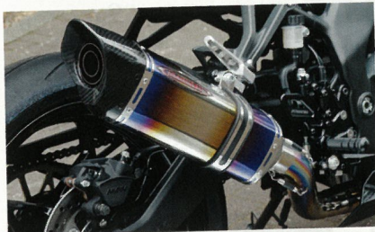
④サイレンサーはシャープなスタイルのニンジャZX-25Rに合わせた、異形断面のインターモデルオフタイプになる。カーボンエンドは共通だが、写真のチタンヒートカラーに加え、素材の質感を活かしたソリッドチタンと、セラコートでブラックアウトされたチタンCKブラックから選択可能
