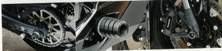
⑥万一転倒した際、極力車体がダメージを受けないようにする各種スライダー類が装着されている。ガードスライダーは標準仕様(写真)・オールブラック仕様・カーボンコンポジット仕様から選択可能(1万4,300~2万7,500円)。アックススライダーフロントは1万780円で、リヤはベースがブラック・シルバーから選択でき、価格は7,150~7,700円になる
