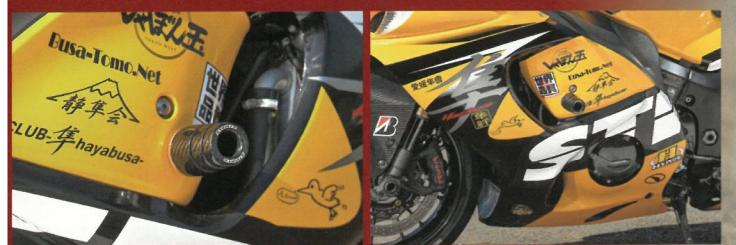
エンジン/フレームはノーマルベースでストライカーラジエーターコアガードやストライカーガードスライダー(カーボンコンポジット)、ストライカーステップ/タンデムステップバー等をセット。ヒールテック・FIT PROサブコンでの燃料調整や同じくヒールテック製クイックシフター/リミッターカッターも加えられる
