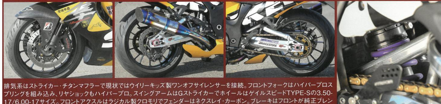
排気系はストライカーチタンマフラーで現状ではウイリーキッズ製ワンオフサイレンサーを接続。フロントフォークはハイバープロスプリングを組み込み、リヤショックもハイバープロ。スイングアームはGストライカーホイールはゲイルスピードTYPE-Sの3.50-17/6.00-17サイズ。フロントアクスルはラジカル製クロモリでフェンダーはネクスレイカーボン。ブレーキはフロントが純正ブレンボキャリパーにアクティブクロスロックディスク
