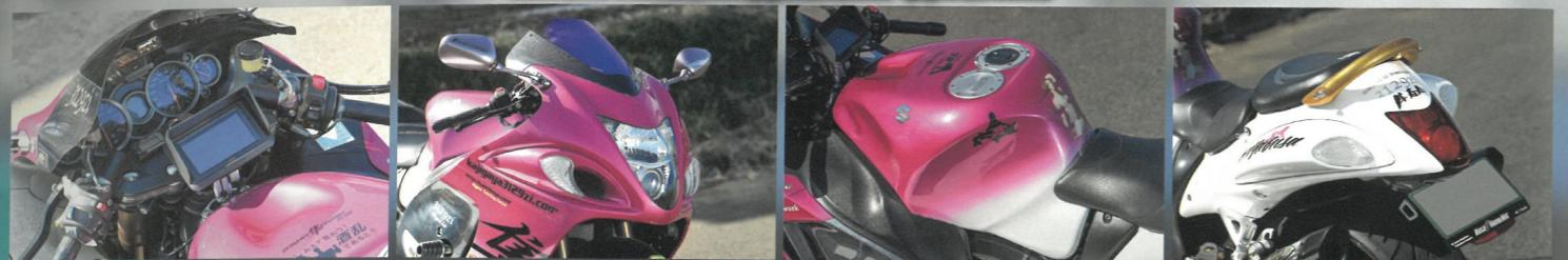
蓮の花をモチーフにしたピンク×ホワイトの外装はこの車両の前に乗っていた'08年型で施したもの移植。燃料タンクは耐久レース仕様のビーター製アルミで、グラブバーも相馬さんの職業にちなんで仮具のゴールドで塗装。テールライトはLED化し、カーボントリム付きのスクリーンはマジカルレーシング。トップブリッジにはハンドル装着位置をノーマル+5/+12/+17mmに調整できるケイファクトリー製スペーサーをセット。左右のブレンボマスターは整備も行き届いていて上々のタッチを維持している
