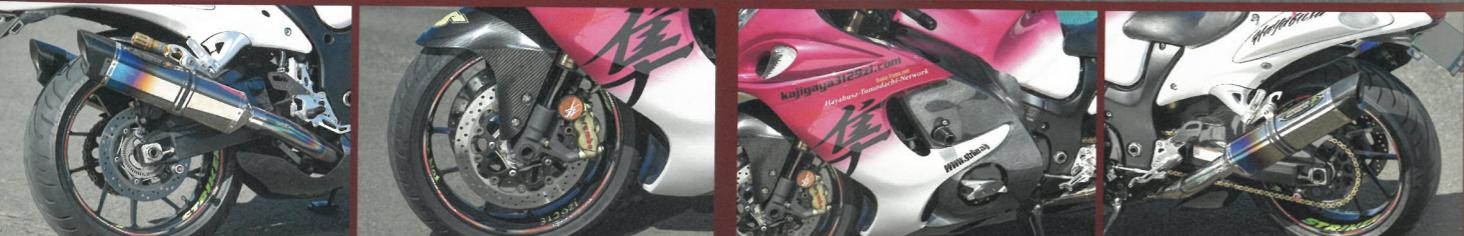
フロントフォークはハヤブサノーマルで、リヤのオーリンズショックとともに良好な作動性をキープ。ステンレスメッシュラインへの変更以外ブレーキはノーマルでホイールは3.50-17/6.00-17サイズのままアルミ鍛造のゲイルスピードTYPE-Rに換装。前後のカーボンフェンダーはマジカルレーシング、2本出しのフルエキはストライカーのワンオフで左右で異なるエンブレムはBusa-Tomo Net専用品。
