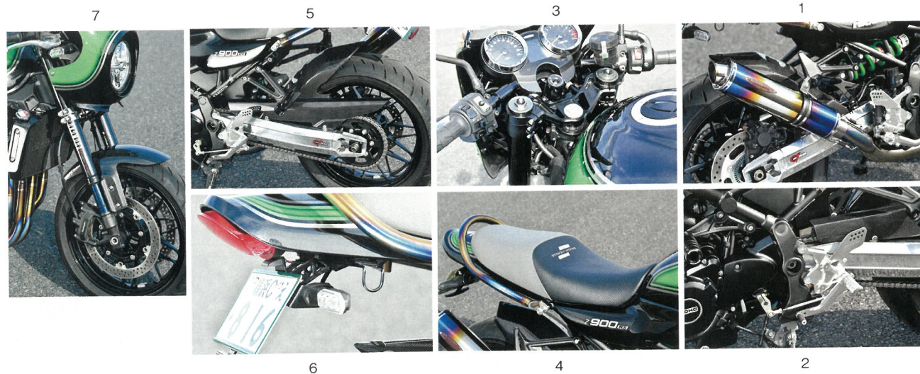
1: マフラーはストライカーの看板パーツ。STREET CONCEPTチタンフルエキゾーストJMCA 4-1 STDを装着 2: ステップは Sports Touring Concept ST EP KIT 4ポジション。基本はブラックアルマイト仕上げで、このシルバーアルマイト仕様はスポット販売されるレアモデル 3: セパレートハンドルはG-STRIKERセパレートハンドルキット。Z900RS用は4ポジション可変、Z900RS-CAFE用は1ポジション固定 4: 手曲げチタン製のグラブバーとシートレザは、ストライカーワークスオリジナル 5: スイングアームはG-STRIKER、インナーリアフェンダーはSTRIKER エアロデザイン 6: フェンダーレスキットもSTRIKER製 7: 前後サスペンションユニットは、ノーマルをベースにスクーデリアオムラでモディファイ。アンダーブラケットはG-STRIKER
