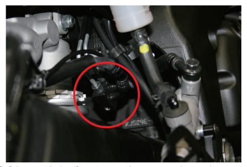
⑤、⑥ポジション選択時、ブレーキホースがフレームと干渉、又は突っ張る場合は、 マスターシリンダーから出ているブレーキホースが接続されるジャンクション部分(リヤショック右側)を 手で引っ張って後方に曲げてホースに余裕を作る必要があります。車両の状態を見て適切に作業を行って下さい。
