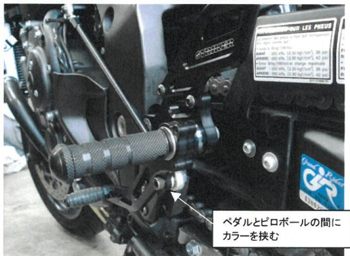
※全てのボルトは必ず本締めしてください。重要な箇所は低強度のネジロック剤を塗布して組み付けてください
