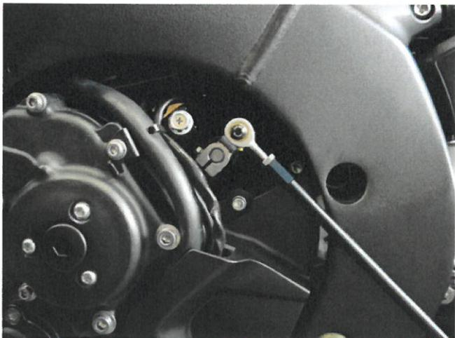
逆チェンジ: 正チェンジとは逆向きにチェンジアームを取り付けます。チェンジアームと干渉しないようホース類の取り回しを変更してください。
