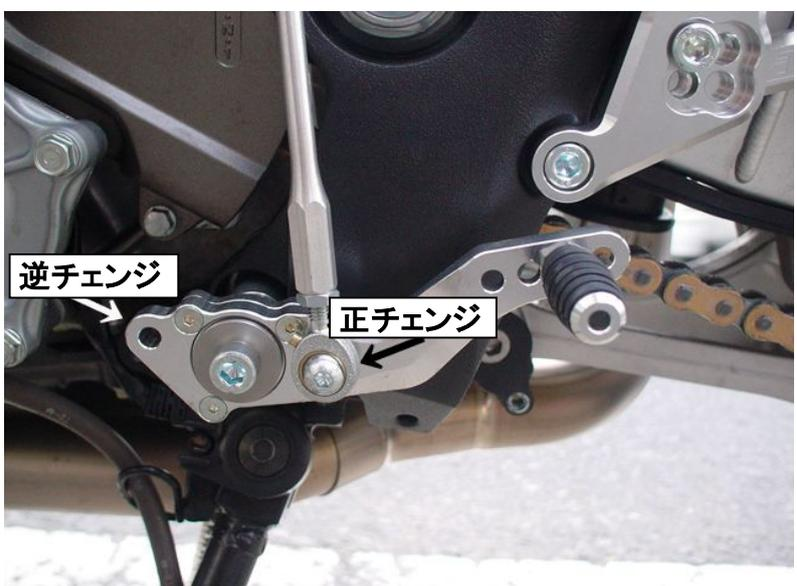
Racing (逆チェンジ)で組み付けされる場合は、インナーカウル (純正カウル内側の黒い樹脂カバー)を、取り外して下さい。
